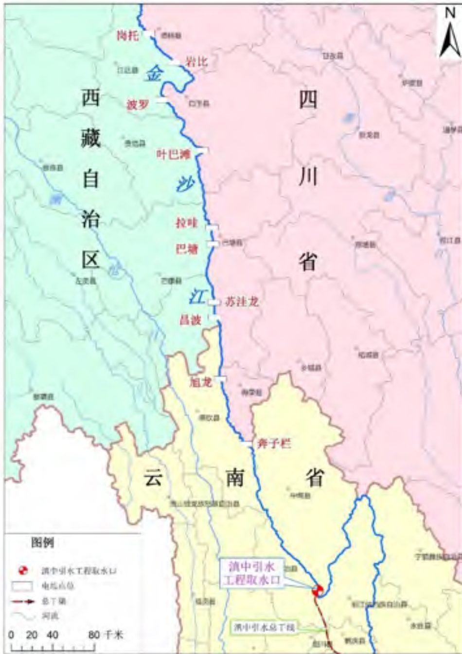
图 3.2.8-1 金沙江上游水电梯级开发示意图
