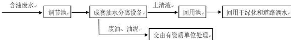
图 6.1.1-5 成套油水分离器处理工艺流程图
